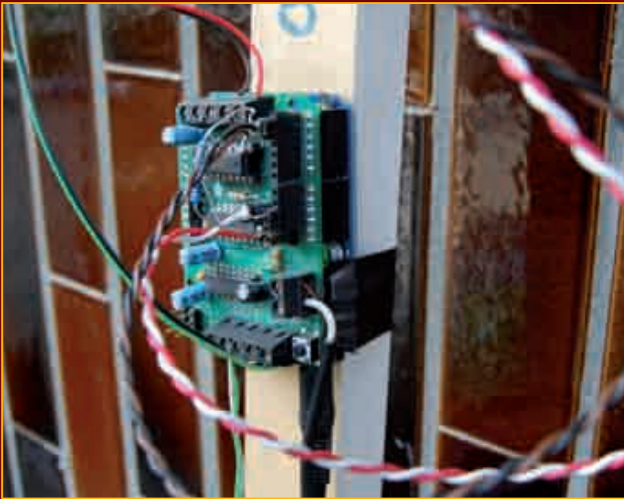
▲ Sull'asta di sostegno trova posto il pacchetto hardware principale controllato da Arduino.
